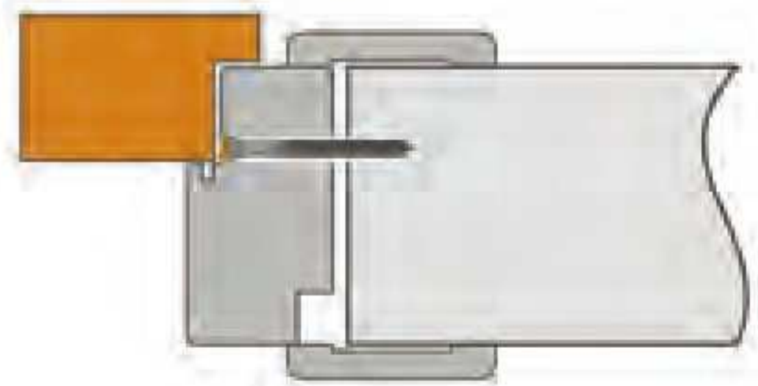
Монтаж в бетонну стіну за допомогою анкерів
