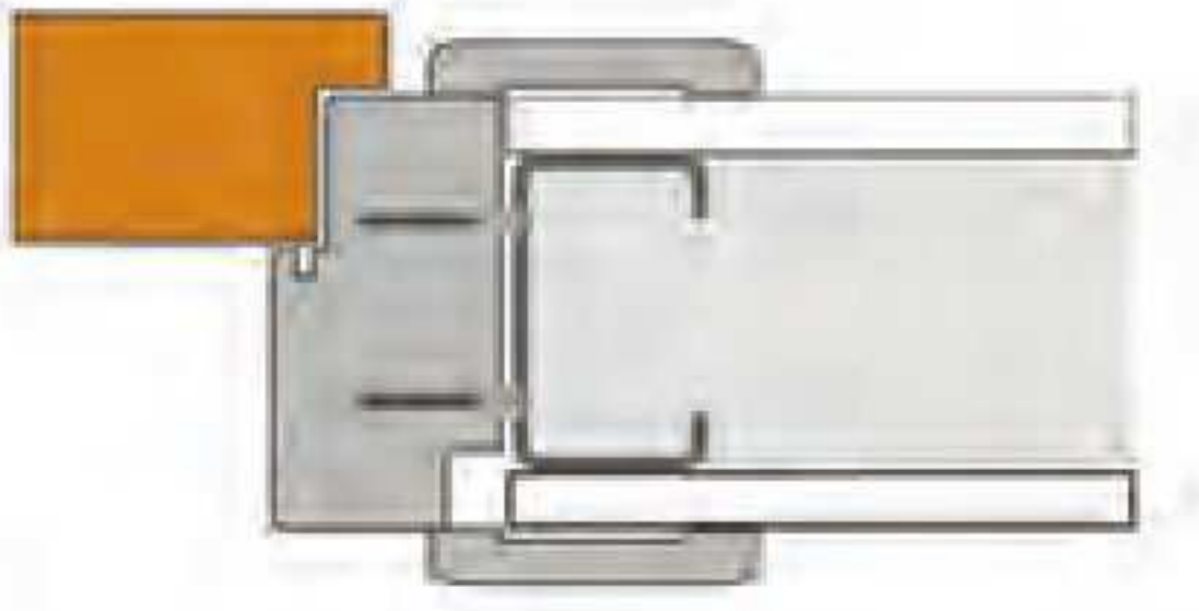
Монтаж в гіпсокартонну стіну за допомогою болтів
